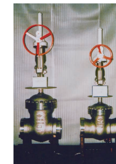
従来型の低温弁(左)と小型低温弁(右)
